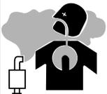
1.b. Opere os motores em local aberto e bem ventilado ou ventile as emissões do motor para fora do recinto.
